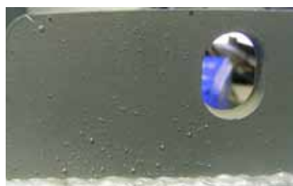
Fig. 4b: Superficie di fissaggio con spruzzi di saldatura nel prodotto di imitazione
