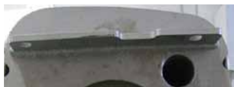
Fig. 4a: Superficie di fissaggio liscia nel silenziatore originale MAN
